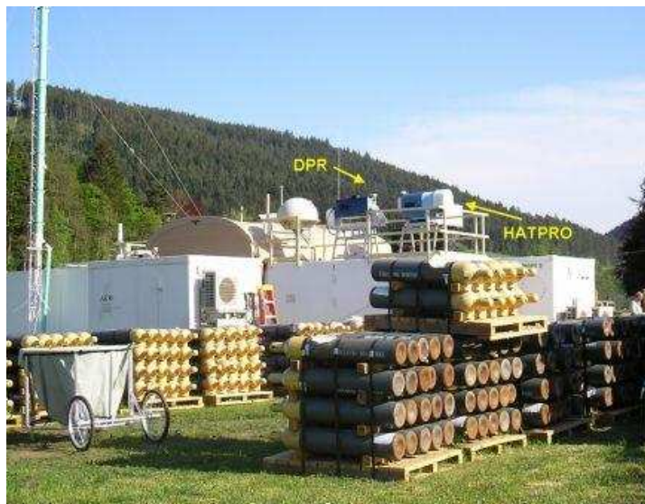
Abbildung 3.1: Standort der „supersite M“ in Heselbach (Nordschwarzwald). Zu sehen sind die verschiedenen Messkontainer der AMF, sowie die von der Universität Köln aufgebauten MWR HATPRO und DPR.
